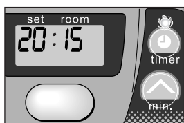
G: El piloto TIMER indica que el temporizador está activado.
